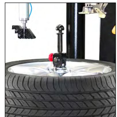
Déblocage par expansion avec le levier à bascule
