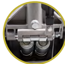
Double pompe : montée rapide
